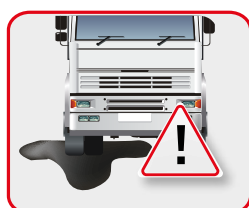
Observe posibles pérdidas
